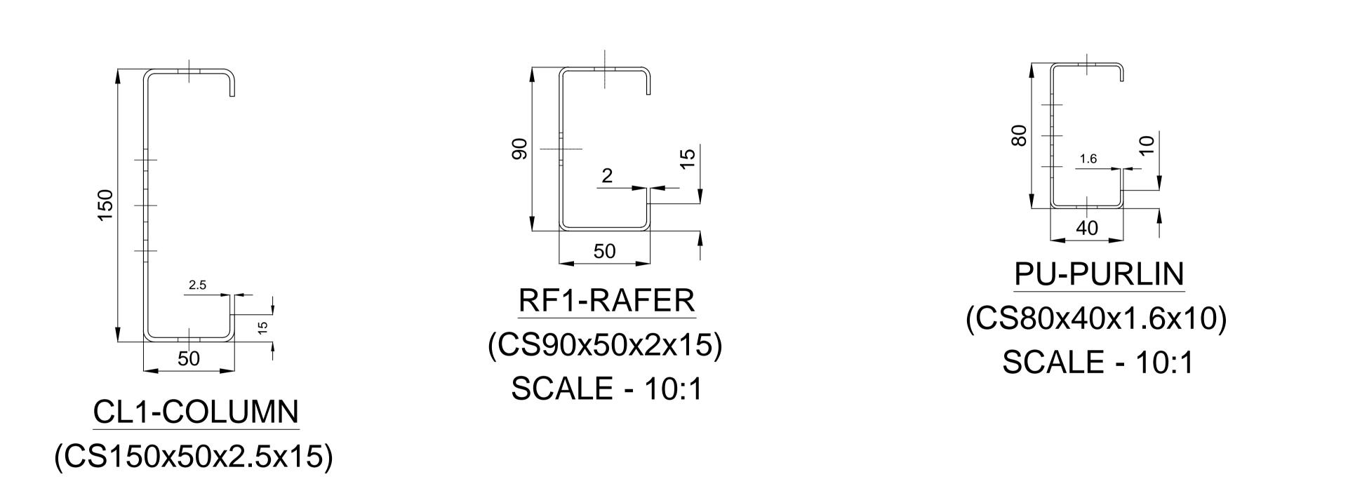
ACCORDANCE WITH IS:2629-1985 AND IS 4759. HOWEVER THE MINIMUM GALVANIZATION THICKNESS TO BE AS PER BOM.
